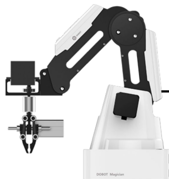
Робот-манипулятор Dobot Magician с 4 степенями свободы
